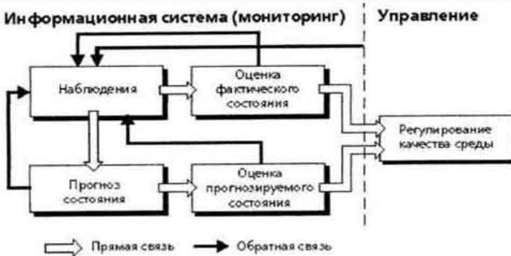
Рис.1. Блок-схема системы мониторинга
